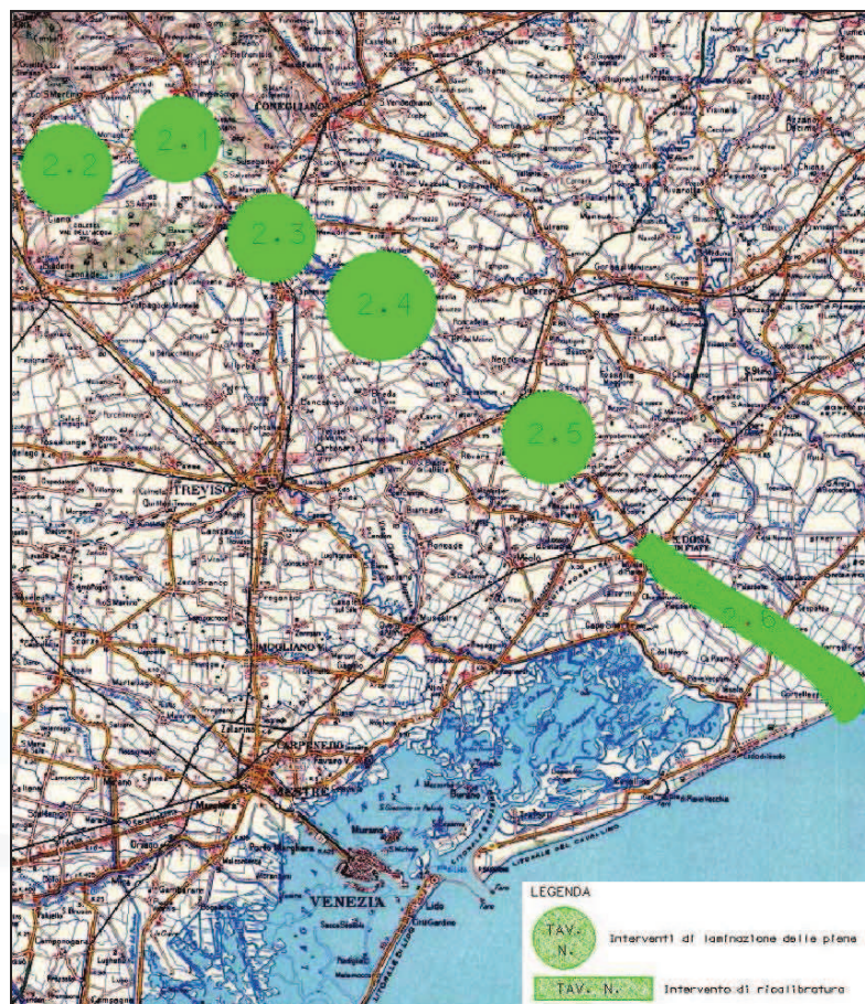
Figura 7– Estratto dal Piano di Stralcio per la Sicurezza Idraulica del corso medio basso del fiume Piave, Possibili interventi laminazione piene e ricalibratura.
